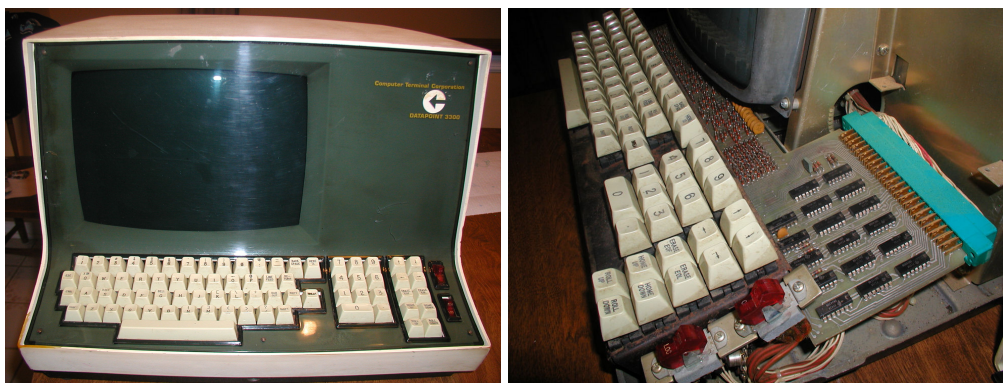
Terminal Datapoint 3300, jeden z pierwszych terminali wyposażonych w pamięć oraz ekran. Źródło: https://www.vintagecomputer.net/CTC/3300/ .
