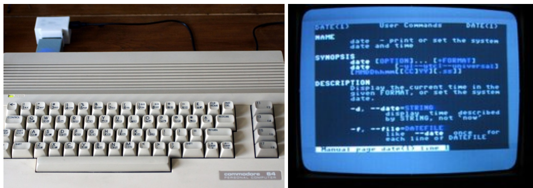
Interfejs portu szeregowego podłączony do komputera Commodore 64 oraz program CaTer, podłączony jako terminal do innego komputera, na którym uruchomiony jest Linux. Źródło: https://www.simulant.uk/ oraz https://sourceforge.net/projects/cater/ .
